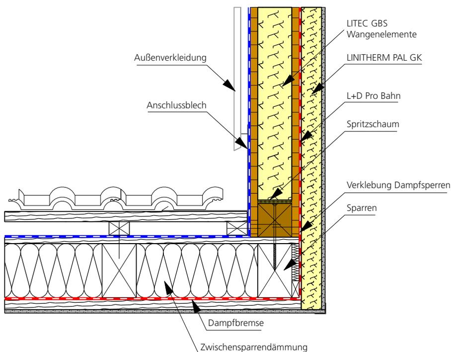
LITEC Gaube mit den entsprechenden Element-U-Werten bei einer Elementstärke von 244 mm mit integrierter Schalldämmplatte
