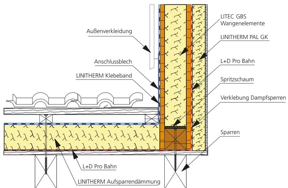
Schnitt LITEC GBS – nicht sichtbaren Dachstuhl mit zusätzlicher Überdämmung der Holzanteile mittels LITEC GS Platte für besseren U-Wert
