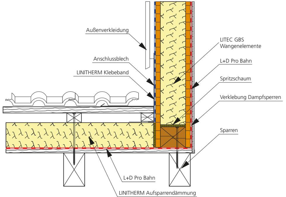
**Schnitt LITEC GBS – nicht sichtbarer Dachstuhl mit Aufsparrendämmung**
