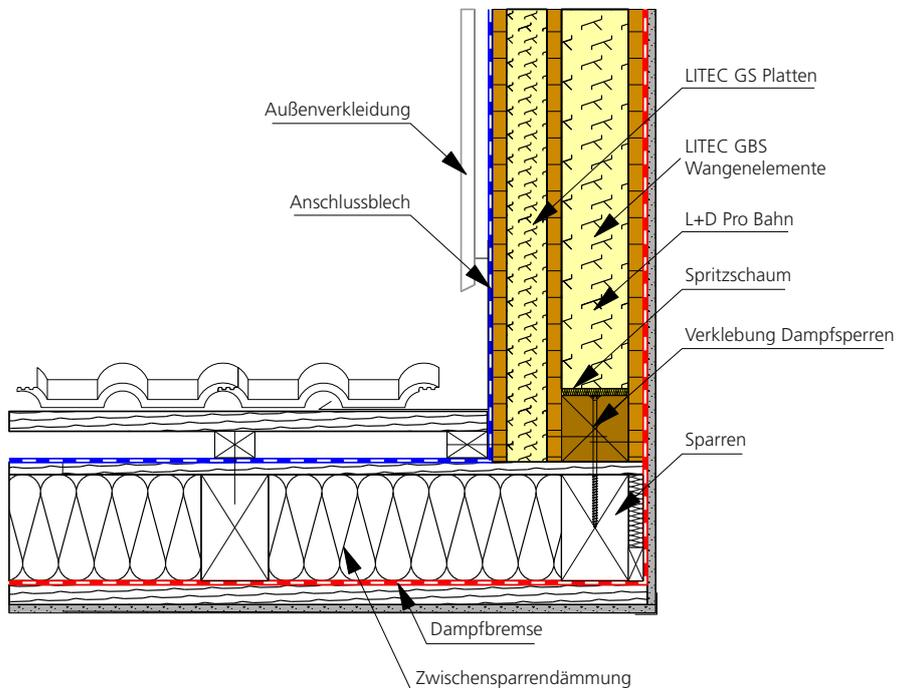
Schnitt LITEC GBS – nicht sichtbaren Dachstuhl mit zusätzlicher Überdämmung der Holzanteile mittels LINITHERM PAL GK auf der Innenseite für einen besseren U-Wert
